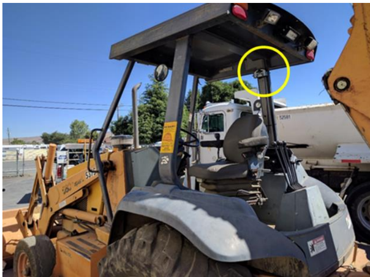
Figure 35: Installation of the GPS EEN Unit in the Excavator
