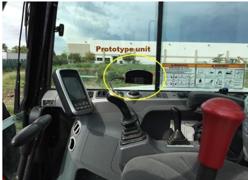
Figure 20: Placement of the GPS EEN Unit in the Excavator
